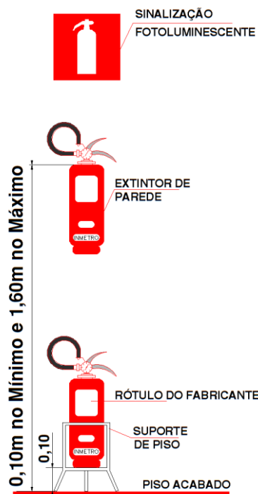
Figura 3: DETALHE DE FIXAÇÃO E SINALIZAÇÃO DO EXTINTOR
